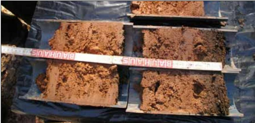
Abb. 2: Probenahme bis zur 60 cm Tiefe im Mineralboden (Foto: Hermann Buberl)
