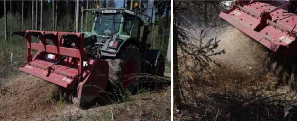
Abb. 2: Mulchaggregat: hierbei wird der mineralische Oberboden gelockert und mit Pflanzenresten durchsetzt.
