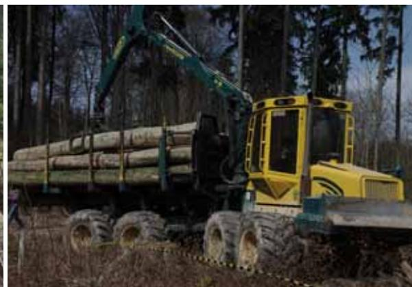
Abb. 1: Beladener Forwarder HSM 208F mit 25t Gesamtgewicht bei der Befahrung der Versuchsfläche
