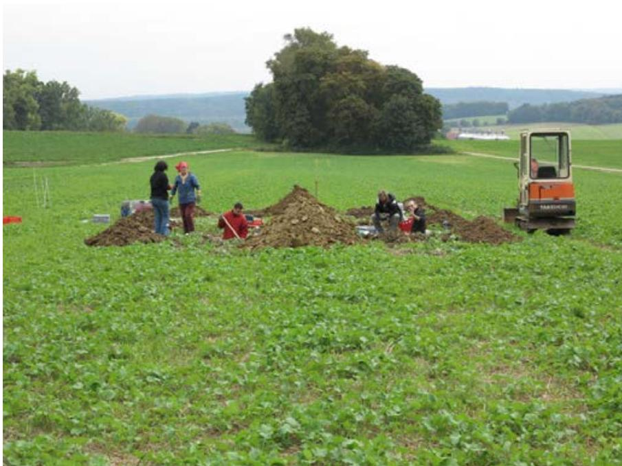
*Abb. 24: Bodenprofile und Probenentnahme auf Betrieb 2 im Herbst 2013. Im Rapsbestand zeichnet sich der befahrene Bereich vom unbefahrenen ab.*
