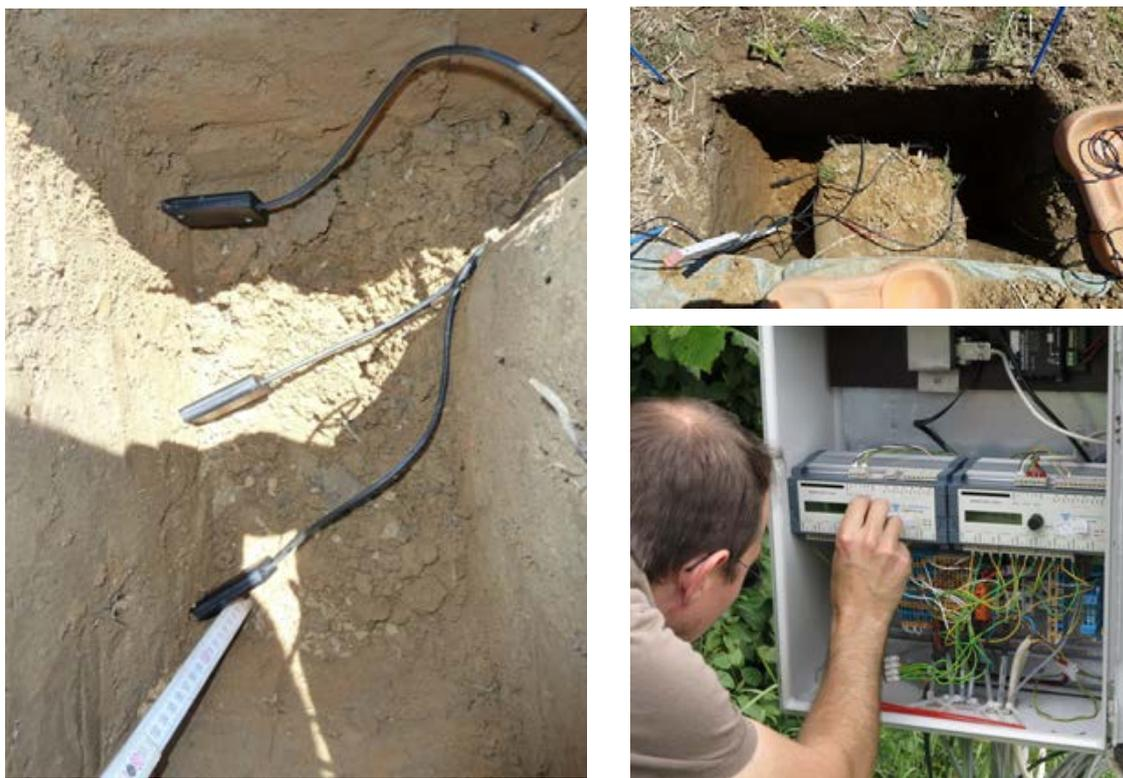
Abb. 5: Links: Einbau der 3 Sensoren in 38 cm Tiefe. Rechts oben: Schacht für den Sensoreinbau mit Einbaupunkten im befahrenen (linke Seite) und unbefahrenen Bereich (rechte Seite). Rechts unten: Datenlogger
