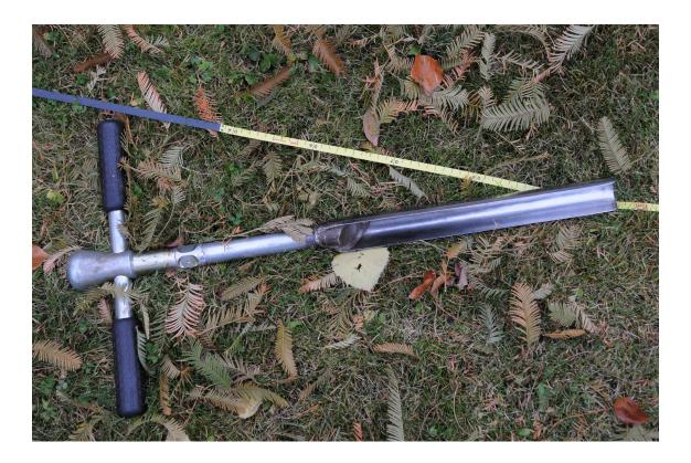
Abb. 15: Darstellung eines Nmin-Bohrers.
