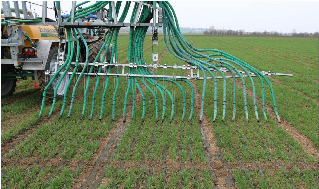
Abbildung 10: Parzellengüllefass mit seitlich geführtem Schleppschlauchverteiler (Arbeitsbreite 4,5 m) zur Ausbringung von Gärresten und Rindergülle bei Silomais (vor der Saat) und Winterweizen (Vegetationsbeginn)
