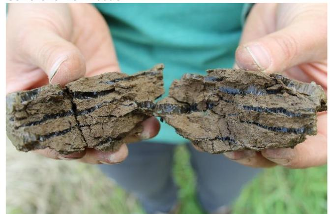
Die genommenen Bodenproben wurden bereits vor Ort aufbereitet und auf Steingehalt und Lagerungsdichte analysiert. Am Thünen-Institut wurden dann Kohlenstoff- und Stickstoffgehalte analysiert sowie an Mischproben auf Phosphor, Textur und Kationenaustauschkapazität untersucht. Auch der pH-Wert wurde bestimmt. Neben einer Fraktionierung der organischen Substanz wurde schließlich auch mittels Kurzzeitinkubationen mit isotopisch markiertem Wasser ( $^{18}\text{O}$ )
