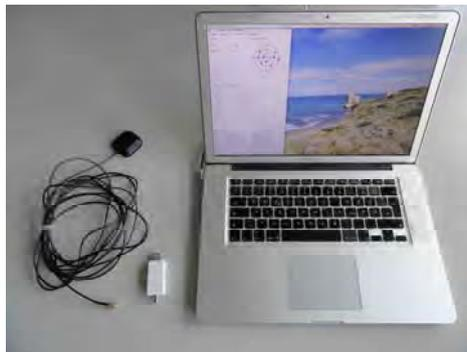
Abbildung 8.18 Software GNSS Empfänger (Gäb und Wehr 2014)
