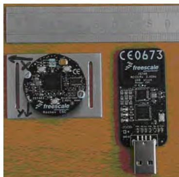
Abbildung 8.13 Sensorplatine und USB-Dongle (Schäfer et al 2011)
