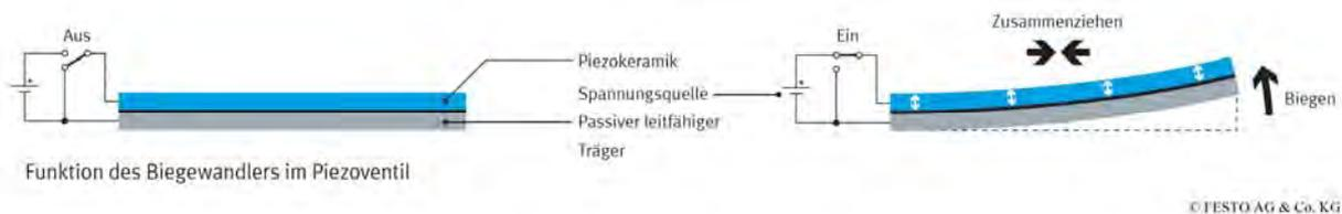
Abbildung 5.17 Prinzip der Piezoventile (FESTO 2014)
