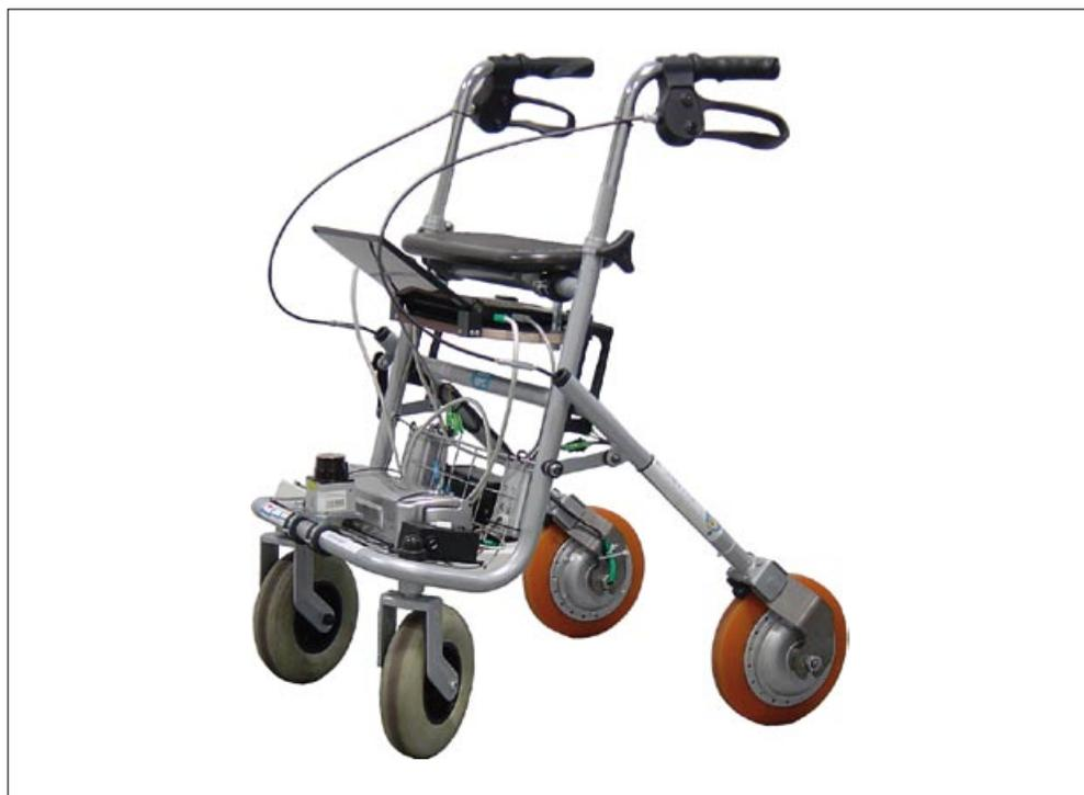
Abb. 3 Prototyp des Rollators iWalker
